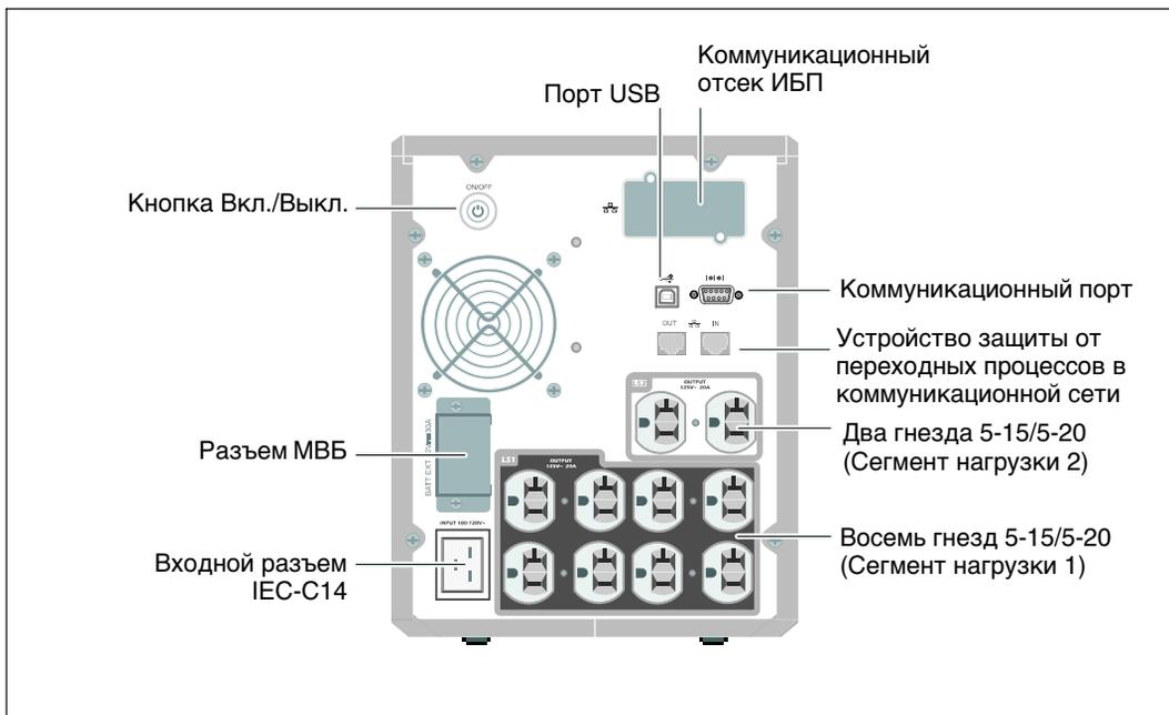
**Рис. 7. Задняя панель 1920 Вт / 120В, 1500Вт / 100 В**
